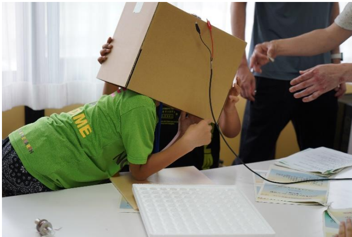
段ボールを振動板にしたスピーカー
