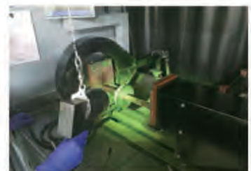
磁粉探傷検査作業風景
