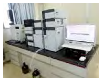
設備：高速液体クロマトグラフィー
