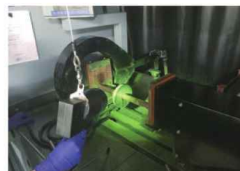
磁粉探傷検査作業風景
